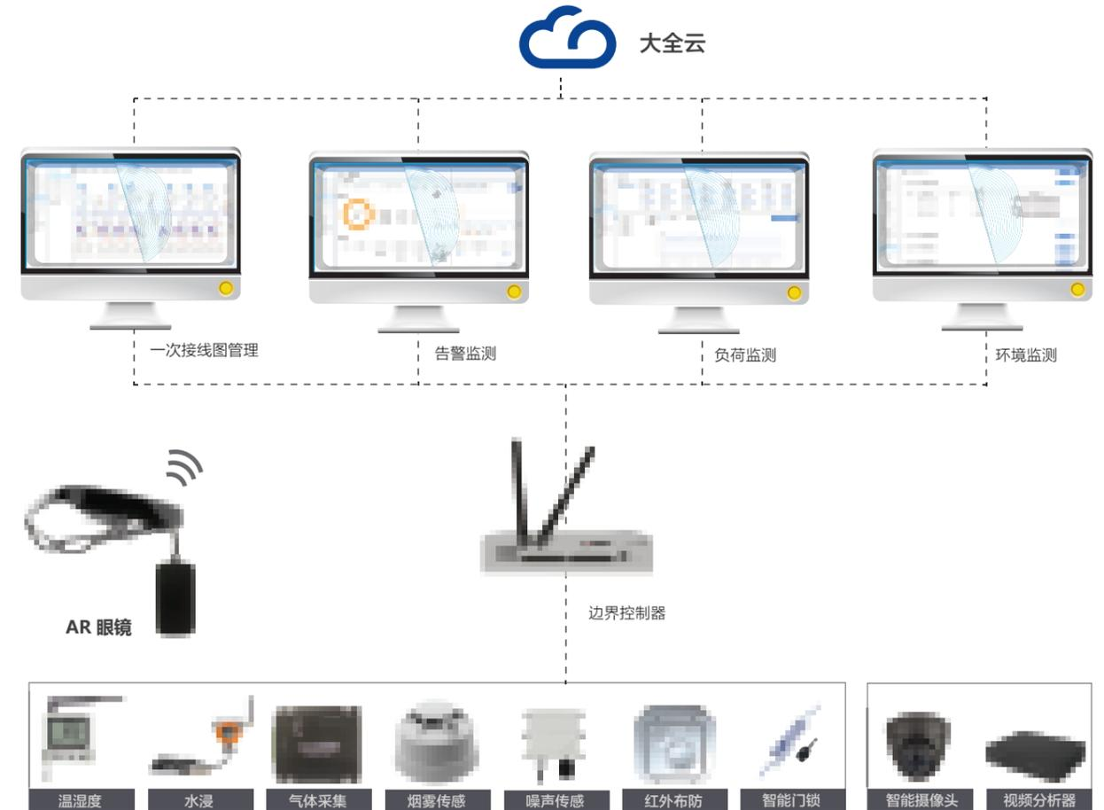
该方案主要面向中低压侧自动化监测与控制,包括中压配电自动化监测、低压柜电气量监测、设备状态监测、环境监测、视频及安防监测等系统。全方位提高配电房各系统信息感知的深度和广度,实现资产精细化管理与设备智能化运维。
